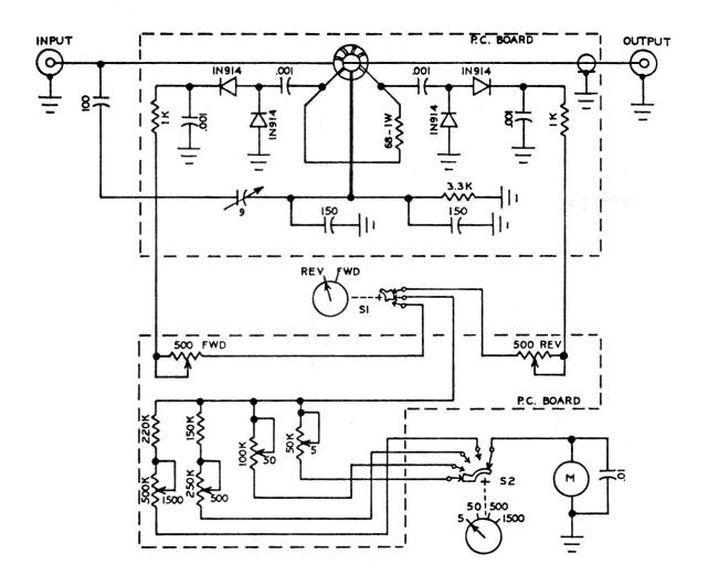
SCHEMATIC DIAGRAM - MODEL WM-1500 WATTMETER
